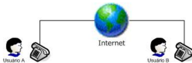
Conexão VoIP usando telefones IP e a Internet
